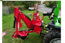
Heckbagger HB66 Anbaubagger Bagger Traktor Zapfwellenpumpe
