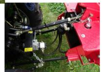
Heckbagger HB76 Anbaubagger Bagger Traktor Zapfwellenpumpe
