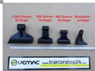
Schlegel Hammerschlegel 400g Böschungsmulcher GEO AGL/AGE
