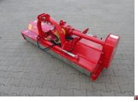
Mulcher FPM M180 hydraulische Seitenverstellung
