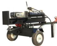
Spalter Holzspalter HSA40 40t 15PS Benzin Motor Anhänger Traktor
